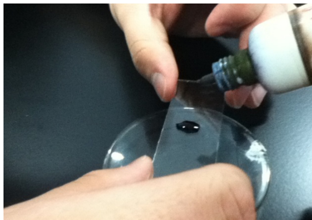
7 - Colocação da lamela
