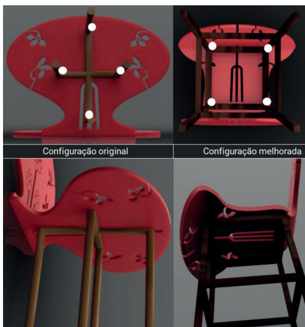
Figura 10 - Comparação entre as pernas originais com as modificadas. Fonte: Elaboração da autora.
