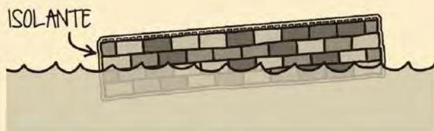
Por cada metro cúbico de água que deslocar, a ponte conseguirá suportar quatrocentos quilos. Um automóvel típico pesará ligeiramente menos que duas toneladas e a nossa ponte precisará de ter um mínimo de dez metros cúbicos de Lego a suportar cada automóvel.
